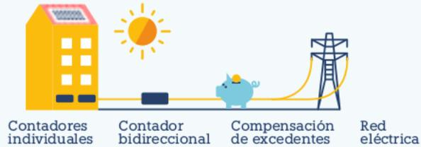
Une autoconsommation avec surplus est une autoconsommation qui, en plus de fournir de l'énergie aux consommateurs, injectera un surplus d'énergie dans le réseau.
